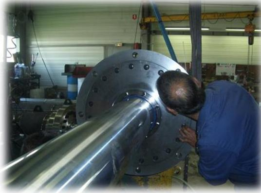
**4 CILINDROS HIDRÁULICOS, DOS PARA CADA CLAPETA**
